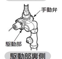
2 カウンター・ボウル下にある 湯側・水側 2 カ所の 駆動部・手動弁を左回りいっぱいに回し、 閉状態にする。
