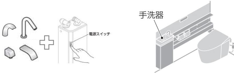
電気温水器の空焚きを防ぐため、下記①⑦⑧⑨⑩⑪の手順で、タンクが満水になっていることを確認してから電源スイッチを「入」にしてください。
