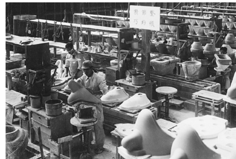
小便器の流し込み成形作業場 昭和初期には石膏型への流し込み成形を行う品番が急増した。
