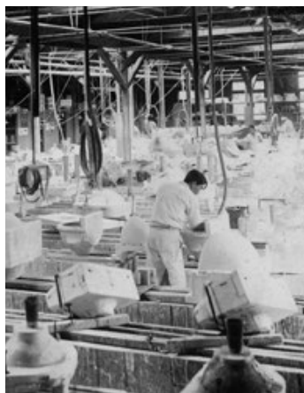
洗面器・流し類の流し込み成形作業
