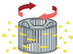
1. 撥油コートをしたファンが回転することで、付着油を弾き飛ばします。
