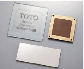
エアロゾルデポジション法によるセラミック膜 セラミックスは通常、高温で焼成しますが、エアロゾルデポジション法はセラミック微粒子を含んだエアロゾルを吹き付けることで、常温で緻密なセラミック膜を作り出します。(第 6 回ものづくり日本大賞内閣総理大臣賞受賞)。
