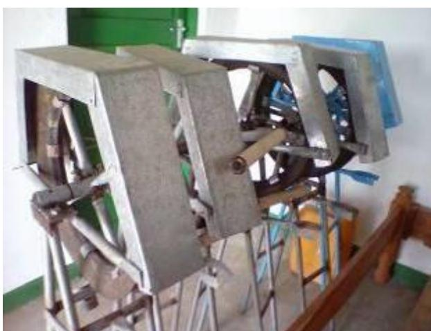
事務所に保管している井戸のロープポンプ。ロープポンプの材料はペンバから車で6時間(現場から10時間)の街で購入しGSBの事務所で製作します。
